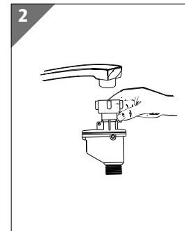
Der Wasserschlauch ist für einen Wasserdruck von ca. 10 bar ausgelegt. Wir empfehlen nach Benutzung den Wasserzulauf zuzudrehen, besonders dann, wenn Ihr Hausanschluss über keinen Druckminderer verfügt.
