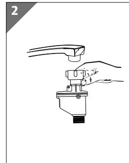
Il tubo dell'acqua è progettato per una pressione di circa 10 bar. Dopo l'utilizzo dell'apparecchio si consiglia di chiudere il rubinetto di afflusso dell'acqua, soprattutto se l'impianto domestico non dispone di un riduttore di pressione.
