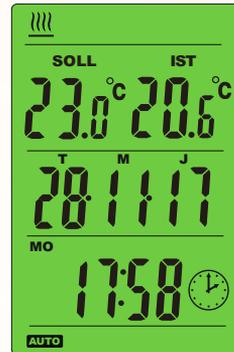
Um eine Einstellung zu ändern, muss das Display eingeschaltet sein (1× Drücken einer beliebigen Taste). Das Display schaltet nach 15 Sekunden selbstständig wieder aus. Wenn Sie eine Einstellung programmieren, schaltet der Thermostat nach 30 Sekunden ohne Eingabe zurück in das Hauptmenü! Bereits gemachte Eingaben werden dabei automatisch gespeichert. Sie sollten daher die Programmierung zügig durchführen!
