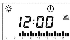
Die vorherige Abbildung zeigt den aktuellen Tag. Unten in der Zeitachse wird angezeigt, dass ab 5 Uhr morgens das Gerät in Betrieb ist.
