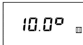
Das Gerät wechselt in den Temperaturmodus von 10 °C.
