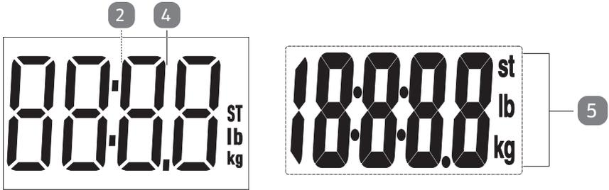
2. Steigen Sie vom Produkt und drücken Sie bei eingeschaltetem Display **2** mehrmals auf die Taste UNIT (MASSEINHEIT) **4** auf der Rückseite des Produkts, um die gewünschte Maßeinheit einzustellen (siehe **Abb. 2**). Auf dem Display erscheint die ausgewählte Maßeinheit **5** (siehe **Abb. 2**). Die Einstellung der Maßeinheit wird für künftige Messungen automatisch gespeichert, bis Sie sie ändern.
