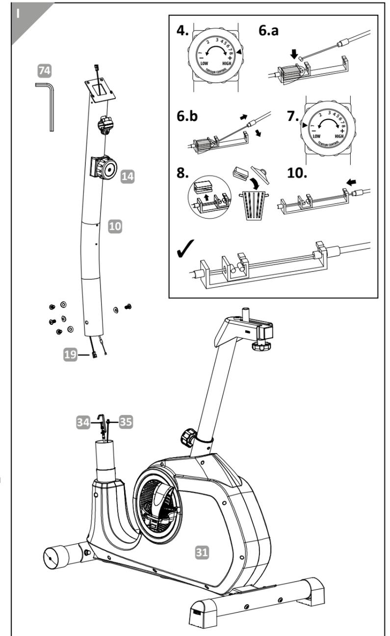
11. Setzen Sie die Lenkersäule 10 auf den Haupttrahmen 31. Zugkabel und Sensorkabel müssen sich dabei innerhalb des Rahmens befinden.
