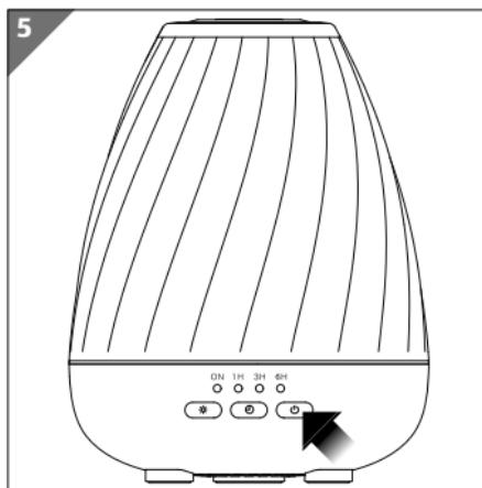
Durante il funzionamento è possibile passare da un'intensità di nebulizzazione all'altra premendo il tasto
