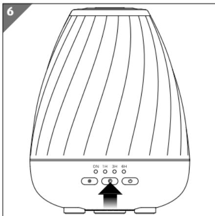
È possibile impostare una durata di funzionamento pari a una, tre o sei ore. Si accende il LED del timer 6 corrispondente.
