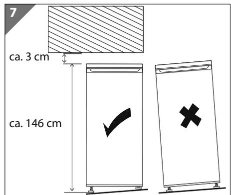
Um die Kühlraumtür **5** vollständig öffnen zu können, müssen die in **Abb. 6** und **7** aufgeführten Raummaße zur Verfügung stehen.
