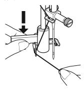
Drehen Sie den Hebel des Einfädlers im Uhrzeigersinn nach hinten.
