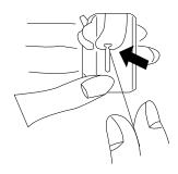
Nun führen Sie den Faden unter der Spannungsfeder hindurch und in das Fadenloch. Versichern Sie sich, dass das Fadenende ca. 15 cm lang ist.
