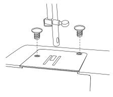
Entfernen Sie mit dem Pinsel Staub und Fadenreste von den Stofftransporteurzähnen.
