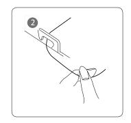
Lassen Sie danach den Faden zwischen den Spannungsscheiben des Oberfadenspannungsreglers 18 durchlaufen.
