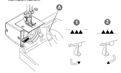
Sollte der Transporteur nicht sofort hochgestellt werden,drehen Sie das Handrad einmal ganz um. Hierdurch wird der Transporteur angehoben.
