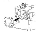
Entfernen Sie den Greifer, indem Sie den Zapfen in der Mitte des Greifers festhalten.
