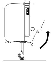
Durch Drücken des Nähfußauslösehebels 22, hinter dem Nähfußhalter, fällt der Nähfuß herab.
