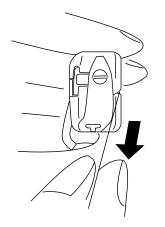
Führen Sie das Fadenende in den Schlitz am Rand der Spulenkapsel ein.
