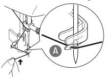
Führen Sie den Hebel des Einfädlers vorsichtig wieder in die Ausgangsposition zurück. Der Fadenfanghaken A zieht den Oberfaden durch das Nadelöhr und bildet hinter der Nadel eine Schlaufe.
