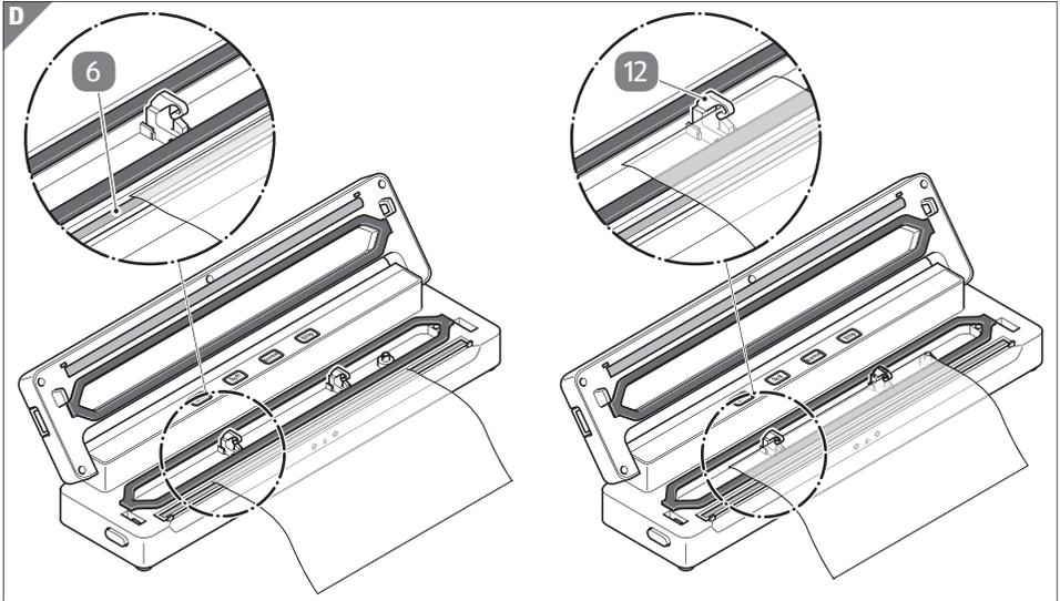
**i** Da ein Vakuumieren nicht erfolgt, muss das Folienende nicht bis an die Folienansläge **12** angelegt werden. Es ist ausreichend, wenn die Folie ca. 1 cm über das Heizelement gelegt wird.
