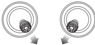
Die Motoren starten automatisch. Drücken Sie den linken Steuerhebel **20** vorsichtig nach vorne, um abzuheben. Hat der Quadrocopter **1** eine Höhe von ca. 1,5 m erreicht, halten Sie den linken Steuerhebel **20** mittig um auf einer Höhe zu schweben.
