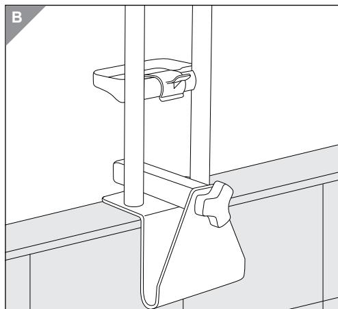
3. Fissare la maniglia per l'accesso girando la vite di regolazione **5** in senso orario finché non è saldamente serrata.
