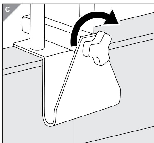
3. Fixez la poignée d'appui en tournant la vis de réglage ⑤ dans le sens des aiguilles d'une montre jusqu'à ce qu'elle soit fermement vissée.
