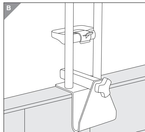
3. Fixieren Sie die Einstiegshilfe, indem Sie die Verstellschraube **5** im Uhrzeigersinn festdrehen, bis sie fest angezogen ist.
