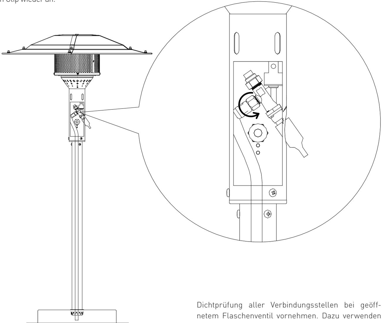
Dichtprüfung aller Verbindungsstellen bei geöffnetem Flaschenventil vornehmen. Dazu verwenden Sie bitte ein Lecksuchspray oder schaumbildendes Mittel (z.B. Gas-Control-Spray oder Seifenlauge). Dieses bringen Sie an den Verbindungsstellen des Schlauches auf. Die Dichtheit ist sichergestellt, wenn sich keine Blasenbildung zeigt.
