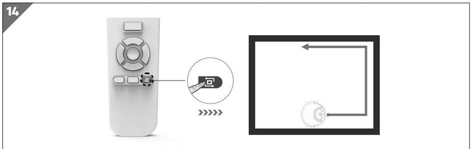
Dopo la pulizia, il robot lavapavimenti si ferma automaticamente e torna al punto di partenza. Il robot lavapavimenti torna al punto di partenza anche se il serbatoio dell'acqua pulita è vuoto, il serbatoio dell'acqua sporca è pieno o se la batteria non è sufficientemente carica.
