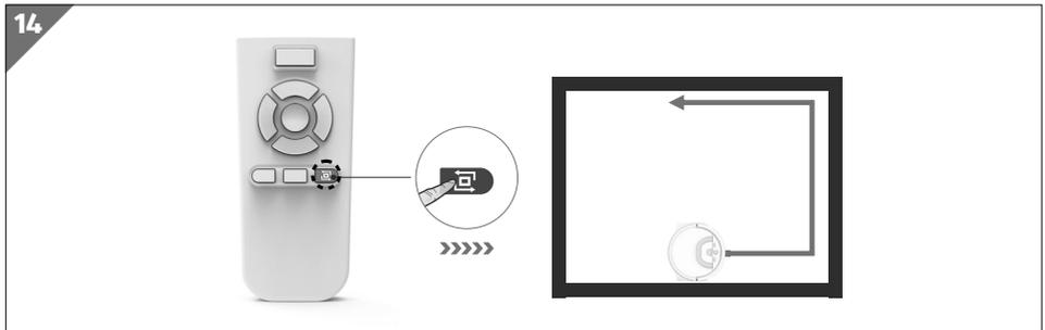
Après le nettoyage, le robot laveur de sol s'arrête automatiquement et revient au point de départ. Le robot laveur de sol revient également au point de départ lorsque le réservoir d'eau fraîche est vide, lorsque le réservoir d'eau sale est plein ou lorsque la puissance de la batterie est trop faible.
