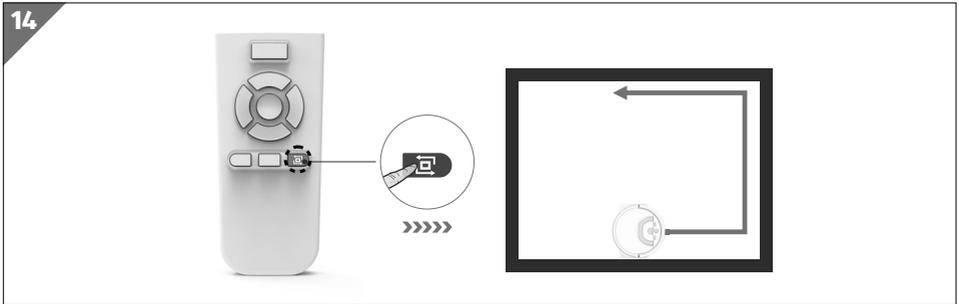
Der Wischroboter stoppt nach der Reinigung automatisch und kehrt zum Ausgangspunkt zurück. Der Wischroboter kehrt ebenfalls zum Ausgangspunkt zurück, wenn der Frischwassertank leer, der Schmutzwassertank voll oder die Batterieleistung zu schwach ist.
