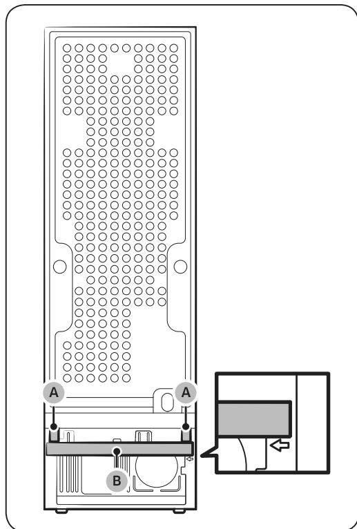
Za optimalno energijsko učinkovitost priložene distančnike (A) in gobico (B) namestite, kot je prikazano na sliki.
