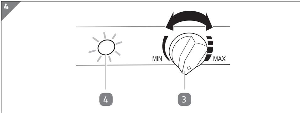
3. Stellen Sie den Temperaturregler **3** auf die gewünschte Temperatur ein. Die Kontrollleuchte **4** geht an und aus, während die eingestellte Temperatur aufrechterhalten wird (siehe **Abb. 4**).
