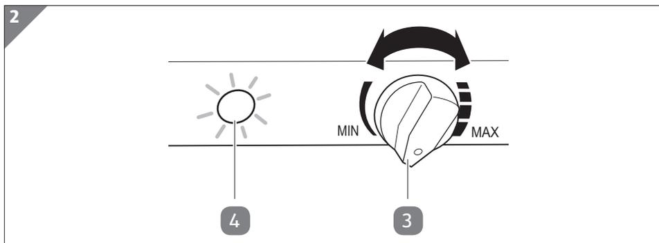
4. Drehen Sie den Temperaturregler **3** im Uhrzeigersinn, um das Produkt einzuschalten. Die Kontrollleuchte **4** leuchtet, bis die eingestellte Temperatur erreicht ist (siehe **Abb. 2**).
