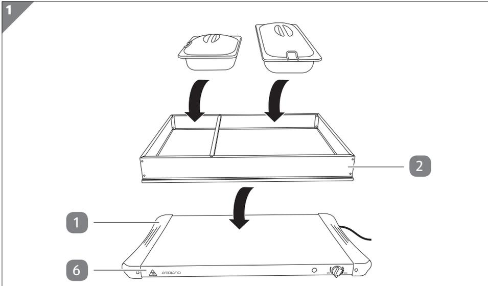
1. Platzieren Sie die Warmhalteplatte **6** auf einer stabilen, hitzebeständigen Oberfläche, und stellen Sie das Gestell für die Servierbehälter **2** sicher darauf. Stellen Sie sicher, dass das Gestell korrekt positioniert ist (siehe **Abb. 1**).
