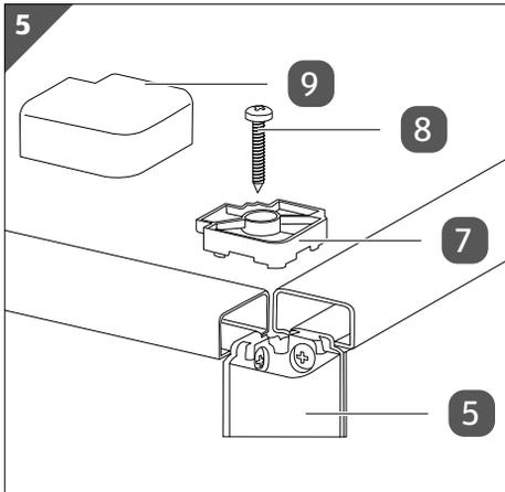
1. Schrauben Sie je eine Klemmplatte **7** mit einer Schraube **8** oben auf jedem Ecksteher **5** fest.
