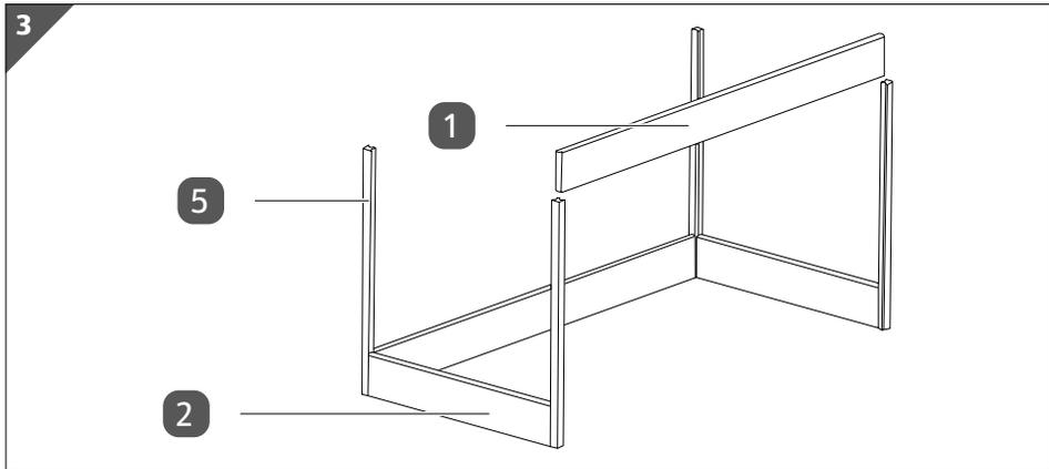
1. Schieben Sie eine lange bzw. kurze Planke **1** und **2** zwischen die Ecksteher **5**, bis Sie ein Rechteck geformt haben (siehe **Abb. 3**).
