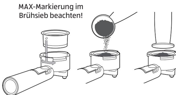
4. Setzen Sie das kleine oder große Brühsieb in den Siebträger ein:
