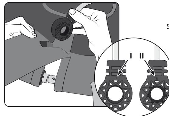
5. Die Kunststoffaufhängung des Seils von oben durch die Öffnung der Lasche mit den Klettbandern schieben. Danach mit der Seite II (siehe Markierung) die Aufhängung auf das dickere Rohr stecken.
