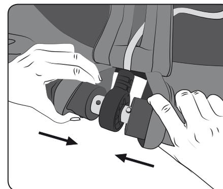
6. Verbinden Sie jetzt die Stangen miteinander und drücken Sie dabei den Federdruckknopf des dünneren Rohrendes herunter. Die Arretierung erfolgt durch das Einrasten und Klicken des Druckknopfes.
