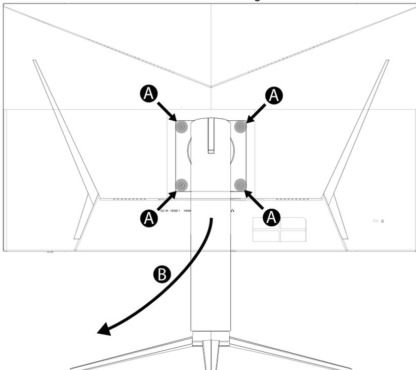
Um die Montage des Gerätes an der Wand zu ermöglichen, nehmen Sie zunächst den Fuß des Gerätes ab.
