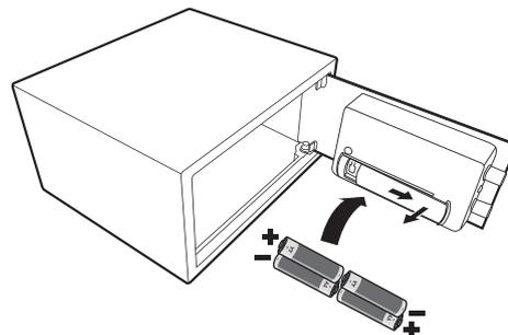
**IMPORTANTE:** Quando il livello di carica della batteria è basso, la spia "LOW BATTERY" (batteria scarica) si accende. Sostituire le batterie come descritto sopra. Ripristinare il codice di accesso dell'utente dopo aver sostituito le batterie.
