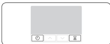
Halten Sie die Tasten und gleichzeitig 3 Sekunden lang gedrückt, um die Kindersicherung zu aktivieren, und halten Sie sie erneut 3 Sekunden lang gedrückt, um das Bedienfeld wieder freizugeben.
