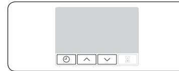
1. Stellen Sie durch Drücken der Tasten und die Stunden ein, und drücken Sie dann . Das Anzeigeelement für die Minuten blinkt.
