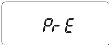
Das Gerät beginnt mit dem Vorheizen und erhitzt den Garraum auf die eingestellte Zieltemperatur. Achten Sie anschließend darauf, dass der Betrieb mit der zuvor ausgewählten Einstellung fortgesetzt wird.
