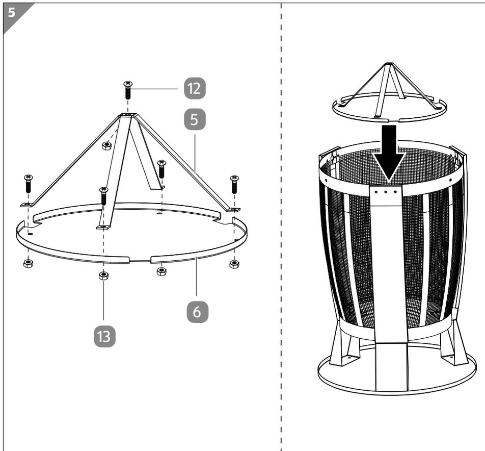
1. Verschrauben Sie die Holzaufsteller **5** und den Feuerraumboden **6** mit den Schrauben M5 × 10 mm **12** und den Muttern M5 **13**.
