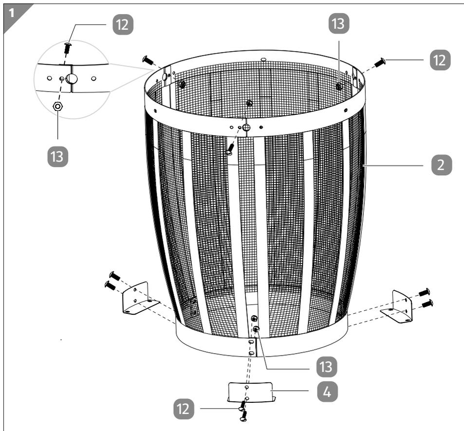
1. Verbinden Sie die Korpuselemente **2** mit den Schrauben M5 × 10 mm **12** und den Muttern M5 **13**.
