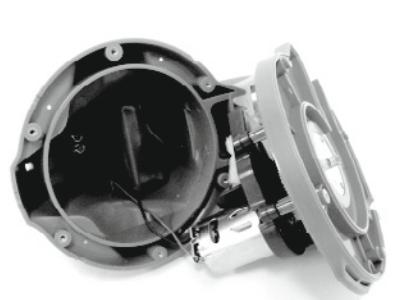
3. Retirez le bloc batterie pour exposer l'assemblage de cartes de circuits imprimés. Pour détacher le câble de connexion de la batterie, appuyez sur le clip sur le connecteur et retirez-le. **REMARQUE** : Enroulez immédiatement le connecteur avec du ruban isolant afin d'éviter tout court-circuit dû au contact des deux fils.
