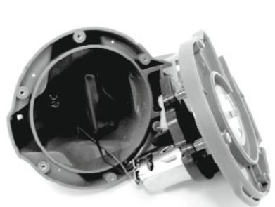
3. Извлеките батарейный блок, чтобы получить доступ к электронному блоку на печатной плате. Чтобы отсоединить соединительный провод батареи, нажмите язычок пружинного коннектора и вытяните провод. **ПРИМЕЧАНИЕ.** Немедленно оберните коннектор изоляционной лентой во избежание короткого замыкания вследствие контакта двух клемм.
