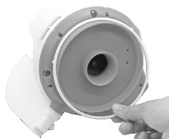
2. Utilize uma chave de parafusos para desaparafusar os 4 parafusos que se encontram no fundo da cabeça para soltar primeiro a placa do fundo. Utilize a chave de parafusos para desaparafusar todos os parafusos na base conforme ilustrado. Remova o impulsor e levante a base e remova-a para expor a cabeça no seu interior.
