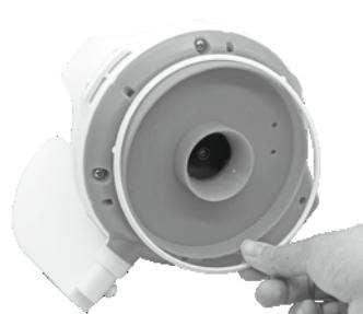
2. Con un cacciavite rimuovere le 4 viti nella parte inferiore della testina, in modo da smontare la piastra alla base. Svitare col cacciavite tutte le viti della base come indicato in figura. Rimuovere la girante, fare leva sulla piastra e rimuoverla, quindi scoprire l'interno.
