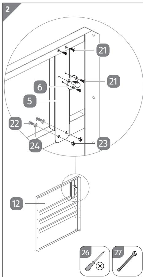
1. Zgornji konec montažne plošče C5 **5** na prikazanih točkah povežite z levo stranico P1 **12**.
