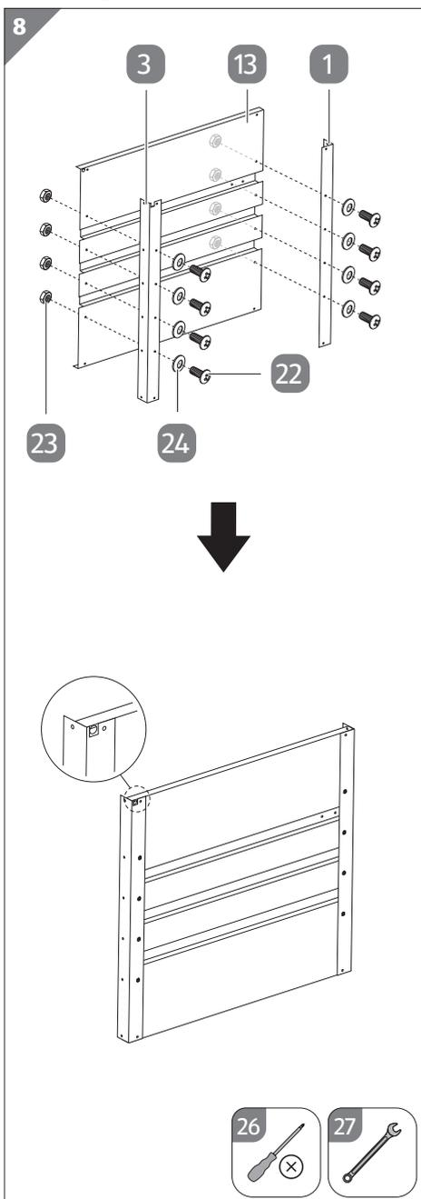
1. En del C1 **1** in del C3 **3** na prikazan način povežite z desno stranico P2 **13**.
