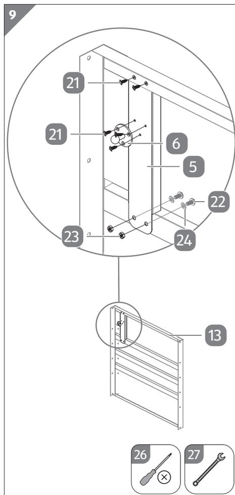
1. Zgornji konec montažne plošče C5 **5** na prikazanih točkah povežite z desno stranico P2 **13**.
