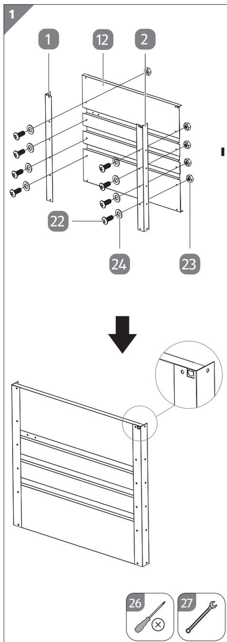
1. En del C1 **1** in del C2 **2** na prikazan način povežite z levo stranico P1 **12**.
