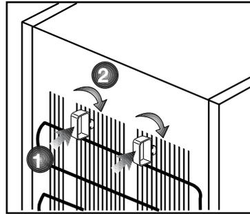
2. Bitte bringen Sie die beiden Kunststoffkeile wie in der Abbildung gezeigt an. Die Kunststoffkeile sorgen für den richtigen Abstand zwischen Gefrierschrank und Wand – und damit für die richtige Luftzirkulation. (Die Abbildung dient lediglich zur Orientierung und muss nicht exakt mit Ihrem Gerät übereinstimmen.)
