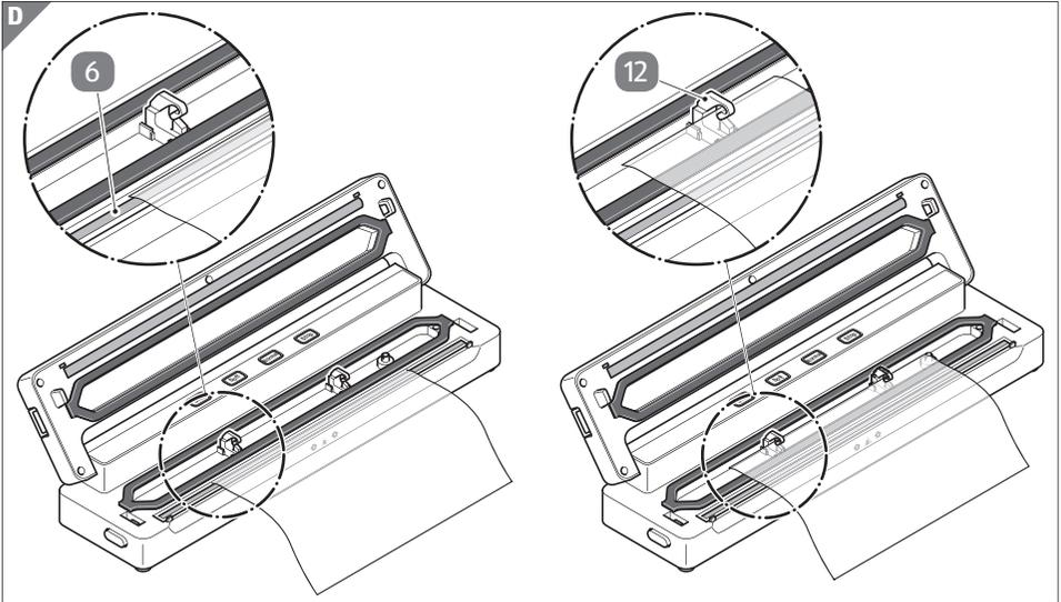
**i** Da ein Vakuumieren nicht erfolgt, muss das Folienende nicht bis an die Folienanschläge **12** angelegt werden. Es ist ausreichend, wenn die Folie ca. 1 cm über das Heizelement gelegt wird.
