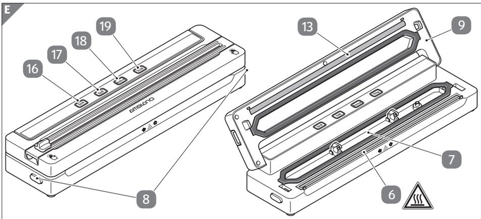
7. Entriegelungstasten 8 beidseitig und gleichzeitig drücken, um die Deckelklappe zu entriegeln.
