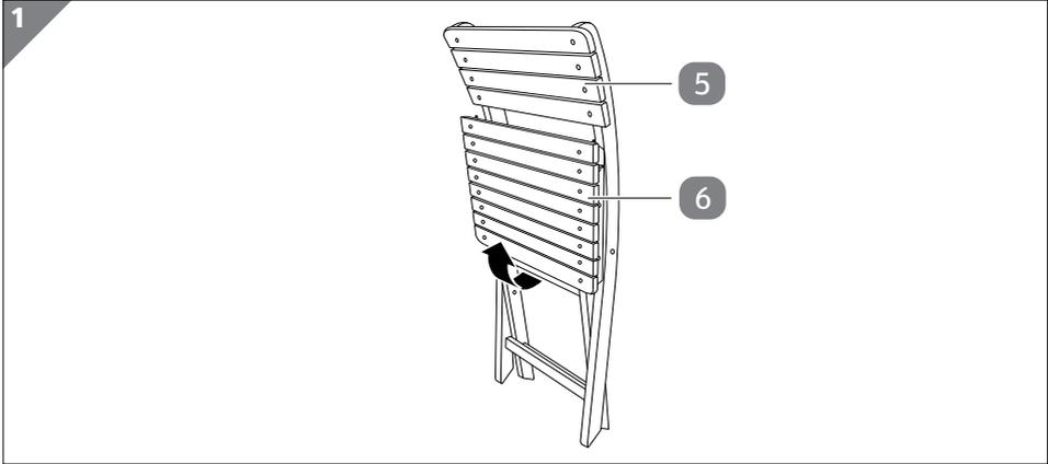
1. Halten Sie den Stuhl mit einer Hand an der Rücklehne **5** fest und ziehen Sie mit der anderen Hand die Unterseite der Sitzfläche **6** nach vorne (siehe **Abb. 1**).
