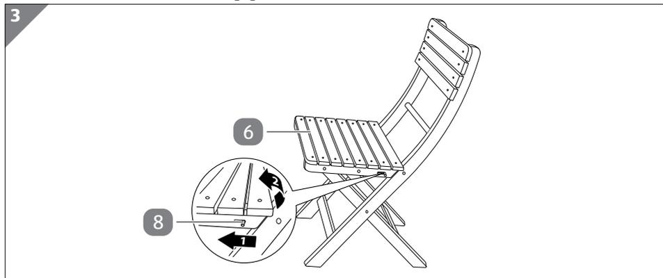
Schieben Sie den Sicherungsstift **8** nach links (siehe Schritt 1 in **Abb. 3**) und heben Sie gleichzeitig den hinteren Teil der Sitzfläche **6** an (siehe Schritt 2 in **Abb. 3**). Schieben Sie den Stuhl so vorsichtig zusammen.
