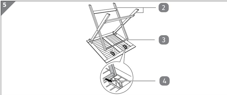
3. Vergewissern Sie sich, dass die Tischbeine **2** vollständig auseinander geklappt sind und der Verbindungsholm **3** sicher in die Halterungen **4** eingerastet ist (siehe **Abb. 5**).
