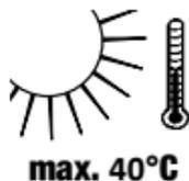
N'exposez pas l'accu à des températures supérieures à 40 °C.
