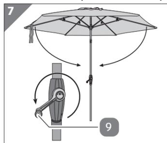
2. Drehen Sie die Kurbel **9** gegen den Uhrzeigersinn, bis das Produkt vollständig geschlossen ist (siehe **Abb. 7**).
