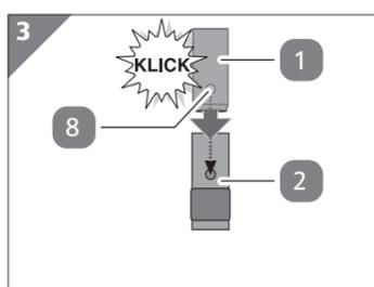
2. Drücken Sie Knopf B **8** und stecken Sie den Schirmmast **1** in das Standrohr, so dass er mit einem hörbaren „Klick“ einrastet (siehe **Abb. 3**).
