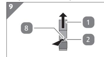
2. Drücken Sie Knopf B **8** und nehmen Sie den Schirmmast **1** aus dem Standrohr **2** (siehe **Abb. 9**).
