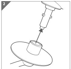
Drücken Sie das Rührwerkzeug nach oben und drehen es im Uhrzeigersinn, bis es einrastet. Ein Rührwerkzeug kann nur dann richtig eingesetzt und gedreht werden, wenn die Führungsnase in der entsprechenden Führungsnut sitzt (siehe **Abb. 3**).
