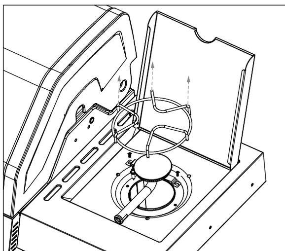
Demontieren Sie Topfrost und Seitenbrenner und gehen Sie zum nächsten Schritt über.
