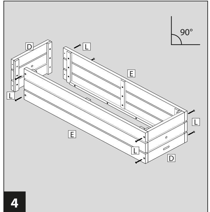
**4** 4 Stück Pflanzkasten zusammensetzen. Verschrauben Sie jeweils zwei Seitenteile Pflanzkasten **D** mit zwei Frontteilen Pflanzkasten **E**. Verwenden Sie dazu jeweils Kreuzschlitzschrauben **L**.
