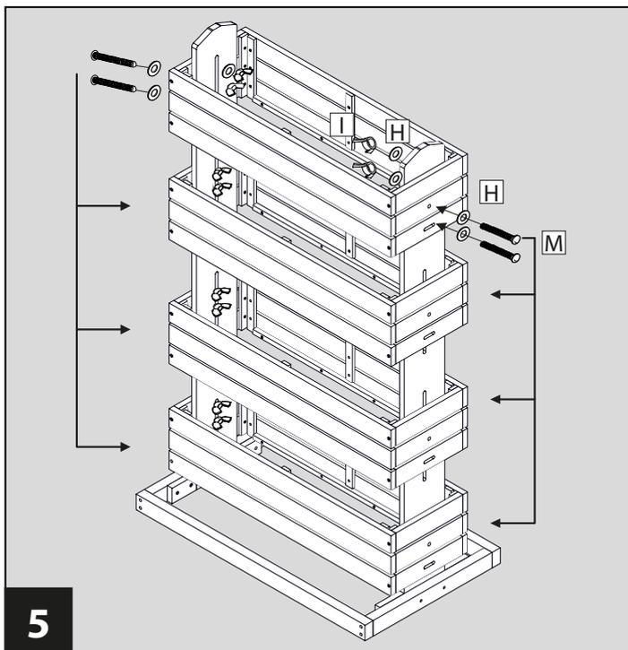
**5** Schieben Sie die fertig montierten Pflanzkästen von oben über die Seitenteile **A**. Befestigen Sie die Pflanzkästen links und rechts jeweils mit zwei Kreuzschlitzschrauben **M**, Unterlegscheiben **H** und Flügelmuttern **I**.
