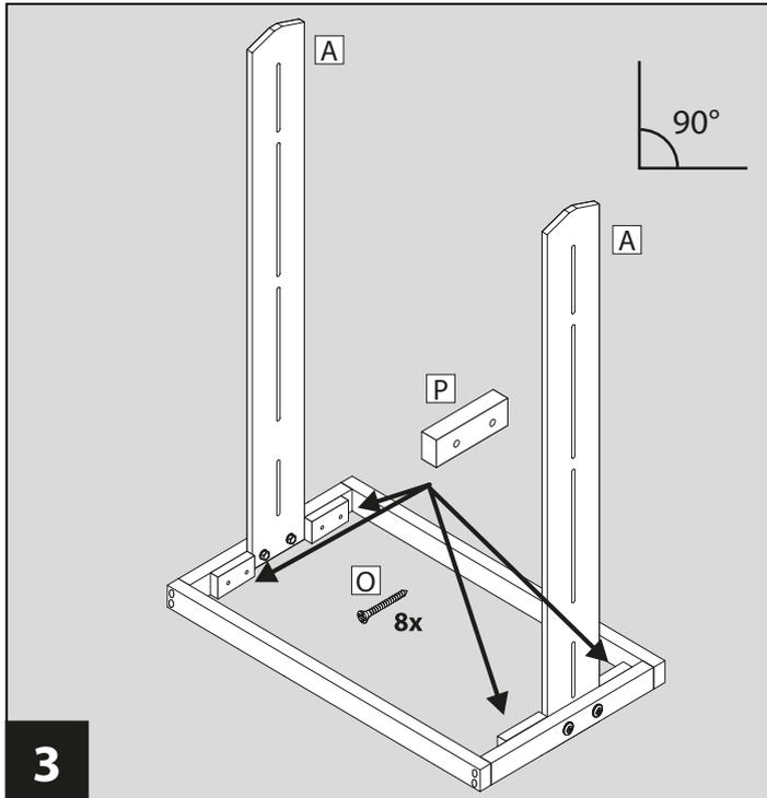
**3** Vier Blöcke **P** jeweils links und rechts von den Seitenteilen **A** befestigen. Die Blöcke **P** müssen dabei ganz an den Seitenteilen **A** anliegen. Blöcke **P** mittels Kreuzschlitzschrauben **O** befestigen.
