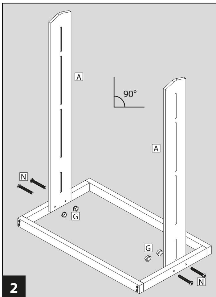
Seitenteile **A** mittels Kreuzschlitzschrauben **N** und Sechskantmutter **G** von innen am vormontierten Standfuß befestigen.
