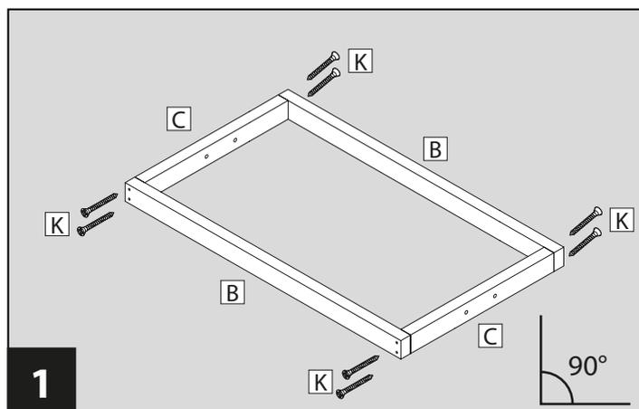
Standfüße lang **C** mit Standfüße kurz **B** mittels Kreuzschlitzschrauben **K** verbinden.
