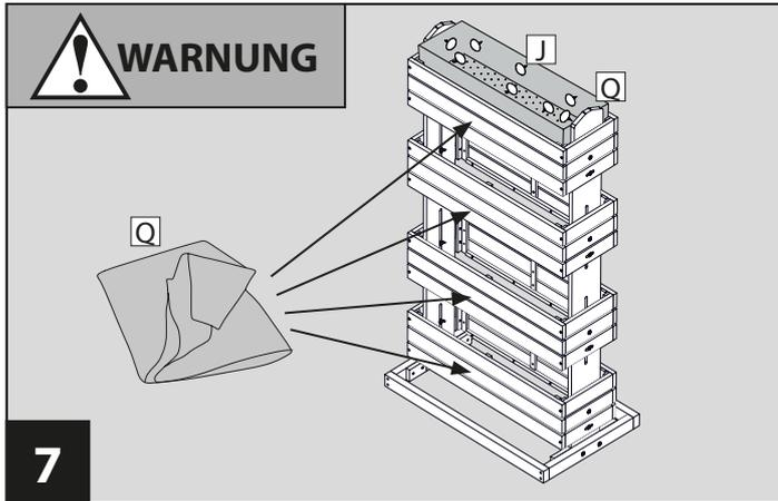
**Achtung:** Vor Einsetzen der Beetplanen **Q** in die Pflanzkästen den gewünschten Neigungswinkel und Höhenposition der Pflanzkästen einstellen. Dazu Flügelmuttern leicht lösen, Pflanzkästen einstellen. Flügelmuttern wieder festziehen. Ist eine spätere, z. B. nach der Bepflanzung, Einstellung des Neigungswinkels gewünscht, so müssen die Kreuzschlitzschrauben innen und die Flügelmuttern außen angebracht werden. D. h. die Flügelmuttern werden von außen aufgeschraubt.
