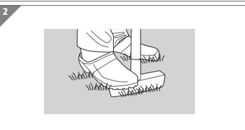
2. Se necessario, ammorbidire con acqua i suoli duri e pietrosi lungo la linea di posizionamento (vedi Fig. 1). Per semplicità, tagliare la linea di posizionamento con un incisore per bordature (vedi Fig. 2). Nel caso di una struttura del suolo morbida, il pretrattamento non è necessario.
