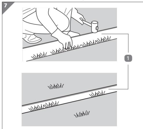
7. Martellare le bordature **1** lungo la linea di posizionamento desiderata con un martello di gomma o di legno (vedi Fig. 7). Non martellare mai direttamente le bordature con un martello metallico, poiché in tal modo possono danneggiarsi.
