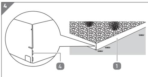
4. Unire due bordature **1** con i ganci di giunzione **3** su entrambi i lati (vedi Fig. 3). Per il montaggio ad angolo di 90°, piegare in modo appropriato le bordature collegate lungo la linea di taglio **4** (vedi Fig. 4).
