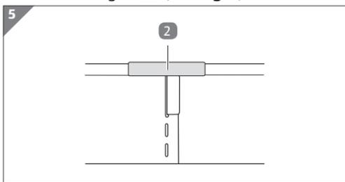
5. Posizionare il morsetto **2** centrato sul punto in cui le estremità si toccano (non è possibile in caso di montaggio ad angolo di 90°) (vedi Fig. 5).
