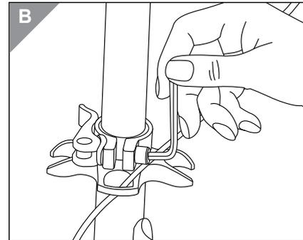
2. Lösen Sie den Sicherungshebel **3** an der Lenksäule **2**.
