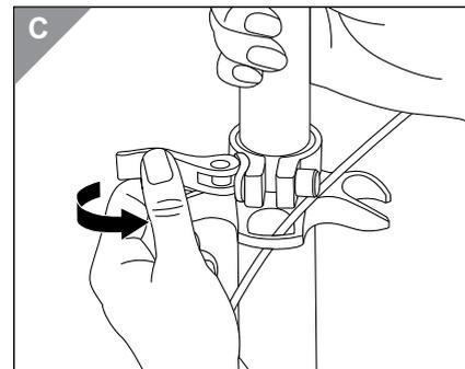
3. Schieben Sie die Lenksäule in die gewünschte Höhe und ziehen Sie den Sicherungshebel **3** fest.
