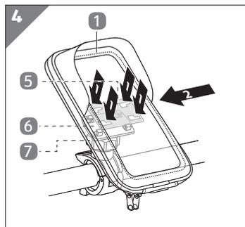
1. Posizionare la custodia 1 con la piastra di bloccaggio 5 sulla piastra di supporto 6 (vedi Fig. 4, fase 1).
