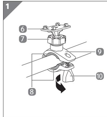
2. A seconda del diametro del tubo del manubrio, utilizzare l'adattatore in gomma 8 o rimuoverlo dal supporto 9 (vedi Fig. 1).
