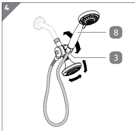
7. Chiudere la doccia. Inserire la doccetta manuale **8** nel supporto **3**. Regolare l'inclinazione del supporto e del soffione doccia in modo tale che il getto d'acqua abbia la direzione desiderata (vedi **Fig. 4**). Il montaggio del prodotto è concluso.
