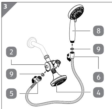
5. Inserire una rondella **9** in ogni lato del tubo flessibile. Avvitare il collegamento per tubo flessibile A **5** alla parte inferiore del deviatore **2** e il collegamento per tubo flessibile B **6** alla doccetta manuale **8** (vedi **Fig. 3**).
