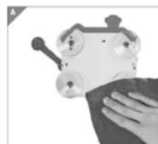
Utilisez un chiffon sec qui ne peluche pas pour nettoyer les ventouses **5** et la surface sur laquelle la machine à glace-mousse doit être fixée. Pour une meilleure fixation, veillez à ce qu'il n'y ait pas d'eau dans la ventouse **5**
