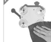
Utilizzare un panno asciutto e senza pelucchi per pulire la superficie su cui applicare le ventose **5** della macchina per schiuma-gelato. Verificare la presa sicura facendo in modo che nella ventosa **5** non ci siano tracce di acqua.
