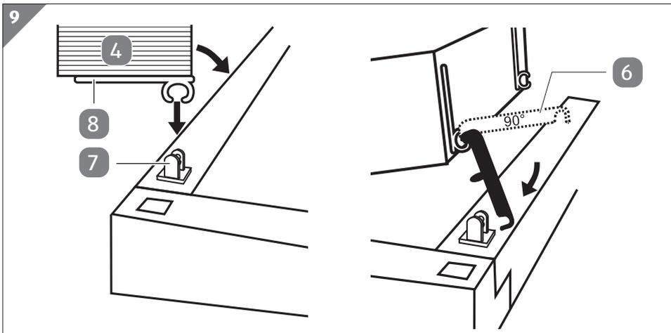
1. Stecken Sie die Gelenkteile **8** in die Scharnierteile **7**.
