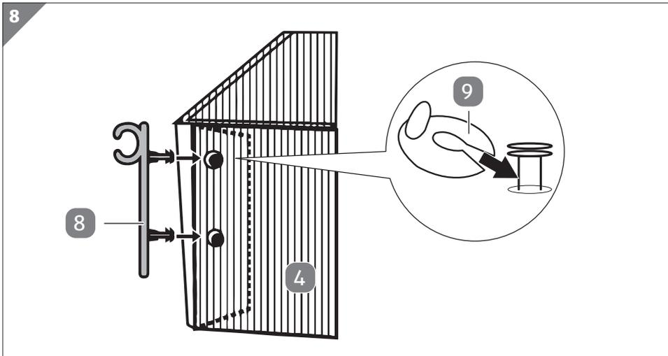
1. Stecken Sie die Gelenkteile **8** durch die Löcher in den Thermohauben **4**.
