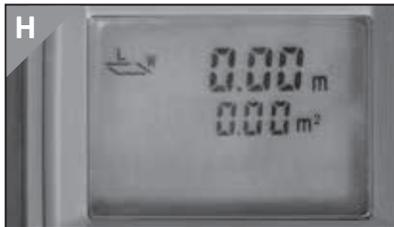
3. Im Display blinkt das „L“ (Länge). Drücken Sie die READ-Taste **6**, um die Länge zu messen. Beachten Sie auch hier die Informationen zum Messen von Entfernungen (s. Abschnitt „Messen von Entfernungen“).
