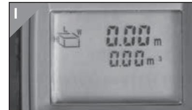
3. Im Display **2** blinkt das „L“ (Länge). Drücken Sie die READ-Taste **6**, um die Länge zu messen. Beachten Sie auch hier die Informationen zum Messen von Entfernungen (s. Abschnitt „Messen von Entfernungen“).
