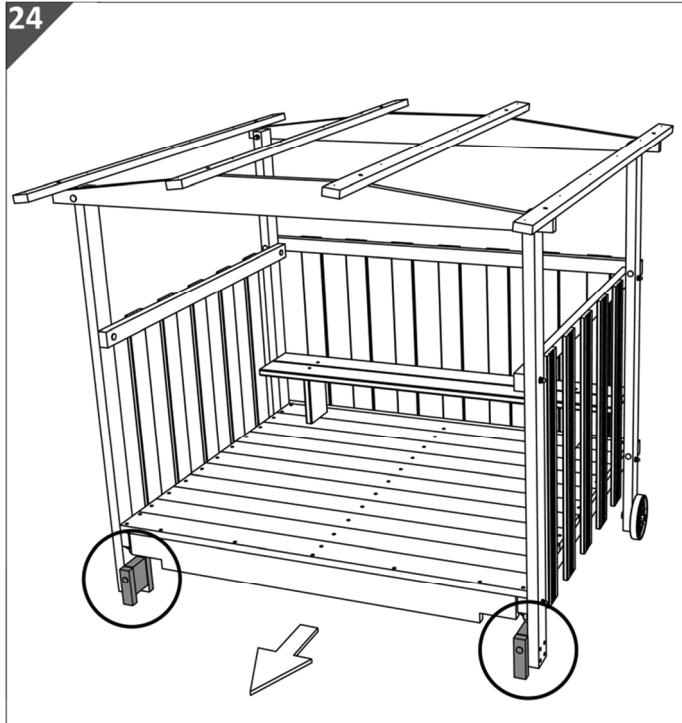
12. Fissare su entrambe le pareti laterali i dispositivi di bloccaggio costituiti da un elemento base di fissaggio **18** e da una guida di fissaggio **20**.
