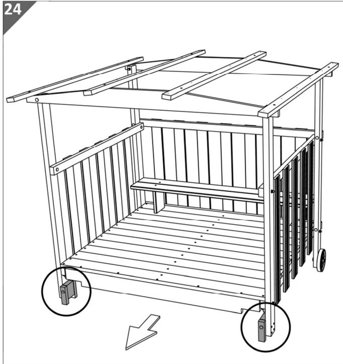
12. Fixez sur les deux parois latérales les dispositifs d'arrêt composés de la pièce de base de sécurité **18** et du verrou de sécurité **20**.
