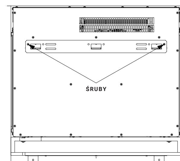
**2.1B** Na stabilnej ścianie zaznaczyć sześć otworów na potrzeby wykonania mocowania. W miejscu zaznaczeń wywiercić otwory za pomocą odpowiedniego wiertła.
