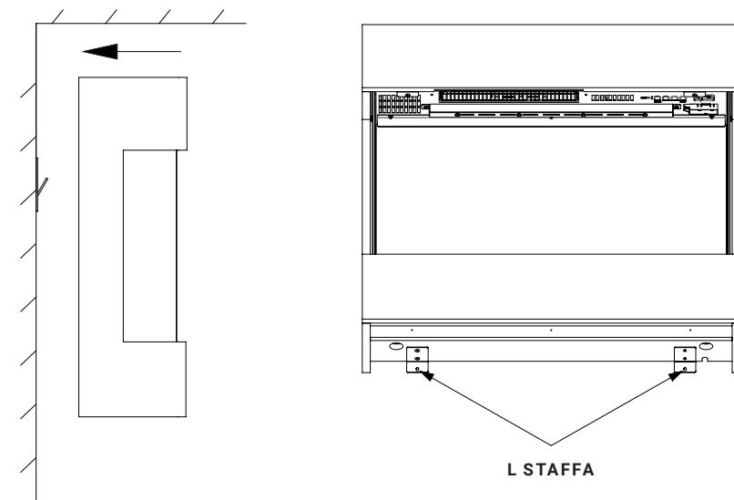
**2.1E** Praticare i due fori con un trapano da 8 mm e inserire i tasselli. Riagganciare il caminetto elettrico e utilizzare le due viti ST5 x 40 per fissare la staffa a L alla parete.
