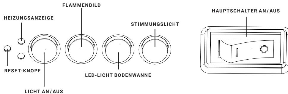
**HINWEIS:** Die manuellen Tasten steuern grundlegende Funktionen, jedoch nicht alle Bedienelementen. Verwenden Sie die Fernbedienung, um alle Funktionen auszuführen.
