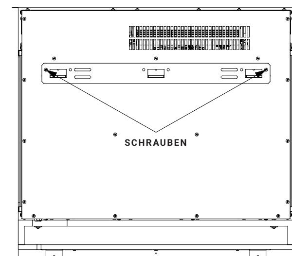
**2.1B** Wählen Sie eine stabile Wand aus und markieren Sie die sechs Löcher der Wandhalterung. Bohren Sie mithilfe des passenden Bohrers, die gekennzeichneten Löcher.
