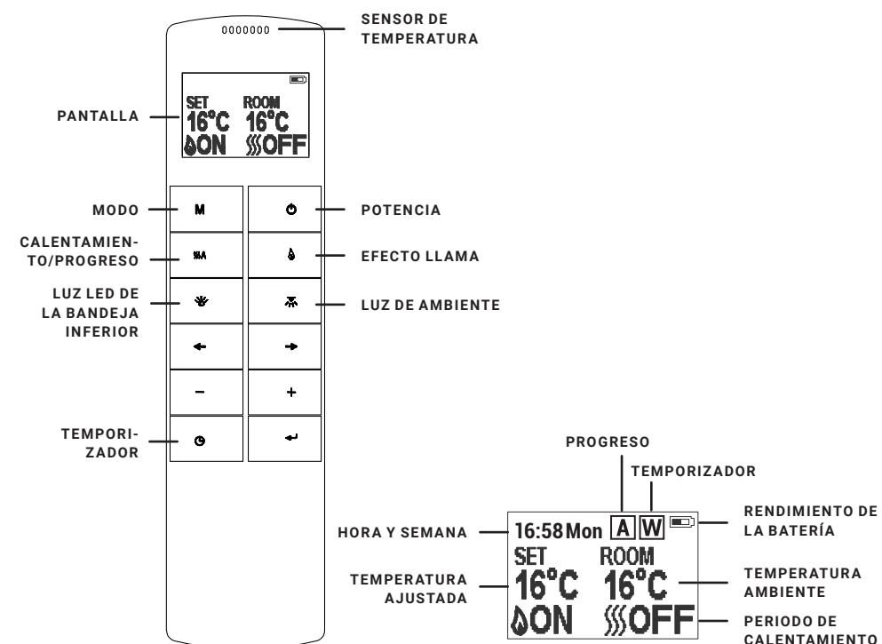
**NOTA:** Se trata de un mando a distancia termostático. El mando a distancia debe estar en la misma habitación que la chimenea y colocarse sobre una superficie plana. El mando a distancia debe colocarse lejos de la chimenea para que el aire caliente no afecte a la lectura termostática.
