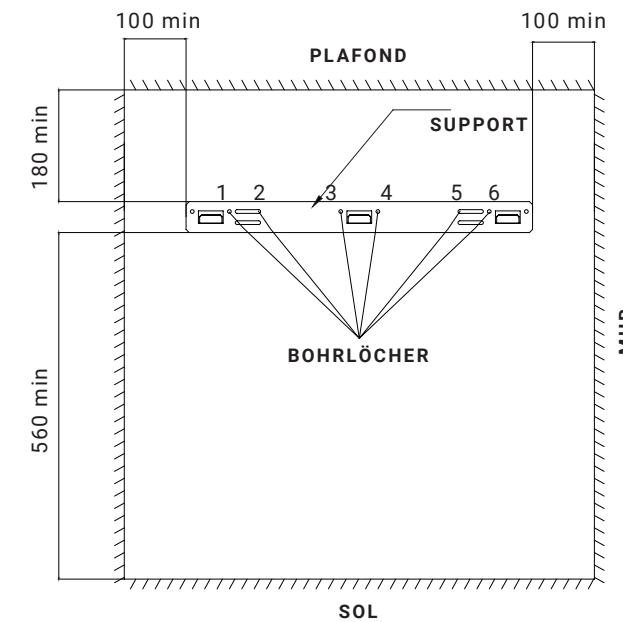
**2.1C** Insérez les chevilles dans les trous percés et utilisez les six vis ST5 x 40 pour fixer le support au mur.
