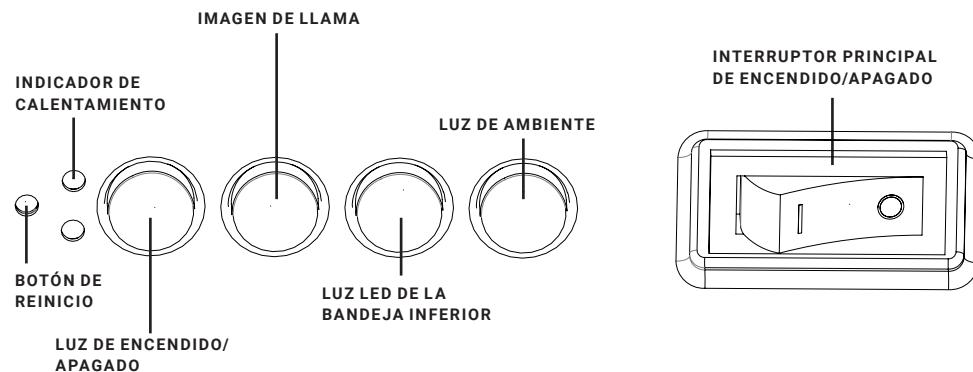
**NOTA:** Las teclas manuales controlan las funciones básicas, pero no todos los elementos de mando. Utilice el mando a distancia para controlar todas las funciones.
