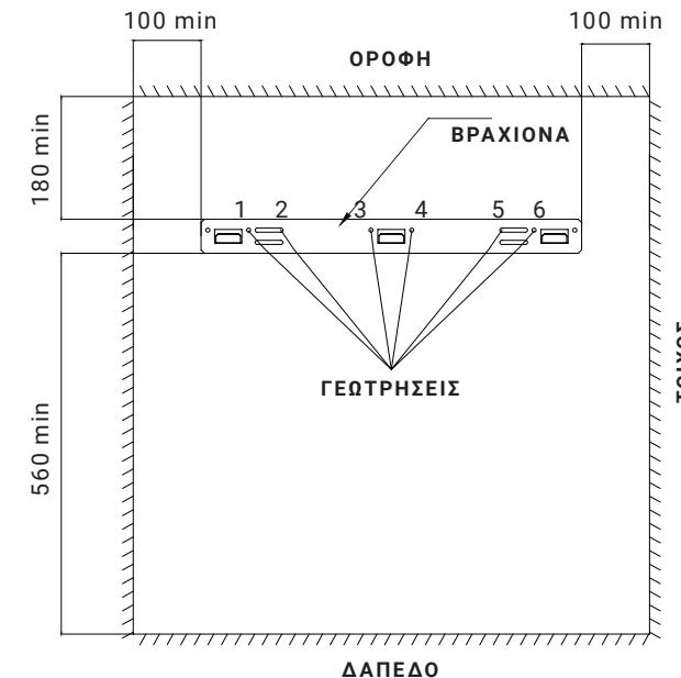
**2.1C** Τοποθετήστε τα βύσματα ούπα στις οπές που έχετε ανοίξει και χρησιμοποιήστε τις έξι βίδες ST5 x 40 για να στερεώσετε τη βάση στον τοίχο.
