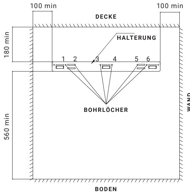
**2.1C** Setzen Sie die Dübel in die gebohrten Löcher ein und nutzen Sie die sechs ST5 x 40 Schrauben um die Halterung an der Wand zu befestigen.
