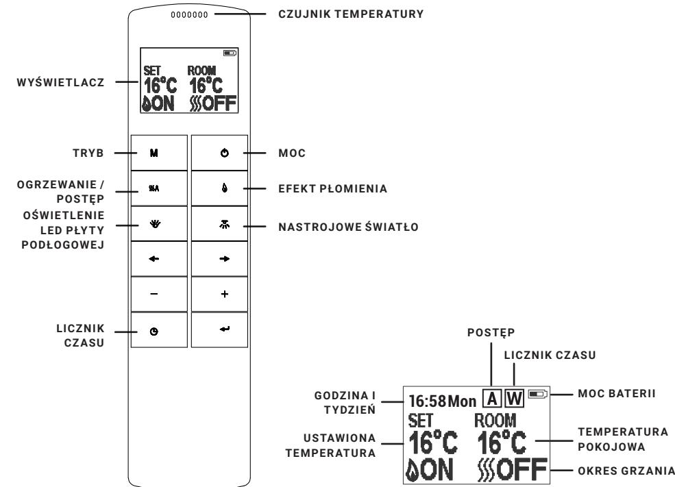
**UWAGA:** To jest pilot termostatyczny. Pilot powinien znajdować się w tym samym pomieszczeniu co kominek i stać na równej powierzchni. Pilot zdalnego sterowania należy umieścić z dala od kominka, aby gorące powietrze nie wpłynęło na odczyt termostatu.
