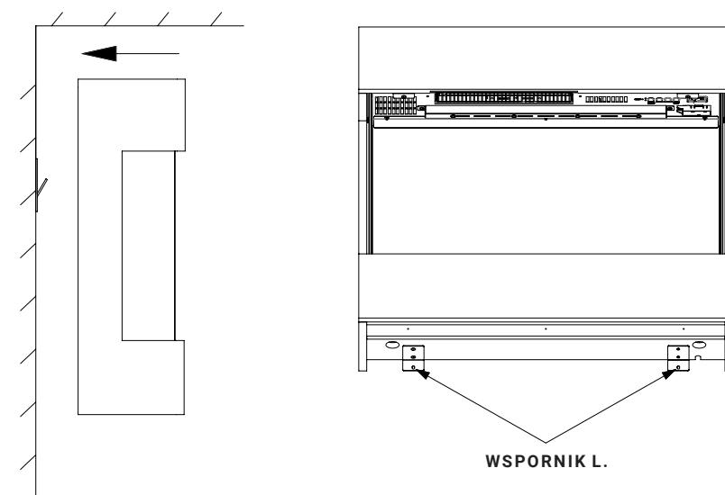
**2.1E** Wywiercić dwa otwory wiertłem 8 mm i włożyć kołki. Zawiesić kominek elektryczny z powrotem na miejsce i użyć dwóch śrub ST5 x 40 do przymocowania wspornika L do ściany.
