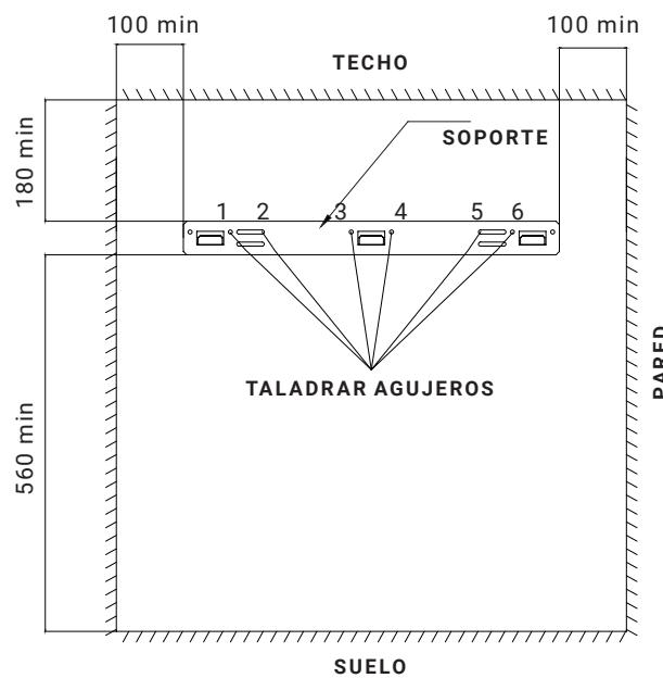
**2.1C** Introduzca los tacos en los orificios taladrados y utilice los seis tornillos ST5 x 40 para fijar el soporte a la pared.
