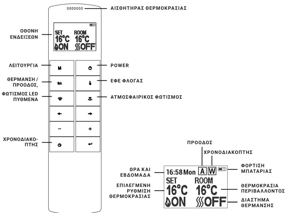
**ΣΗΜΕΙΩΣΗ:** Πρόκειται για ένα θερμοστατικό τηλεχειριστήριο. Το τηλεχειριστήριο πρέπει να βρίσκεται στον ίδιο χώρο με το τζάκι και τοποθετημένο σε μια ομαλή επιφάνεια. Το τηλεχειριστήριο πρέπει να τοποθετείται μακριά από τζάκι προκειμένου ο θερμός αέρας να μην επηρεάζει τη θερμοστατική τιμή μέτρησης.
