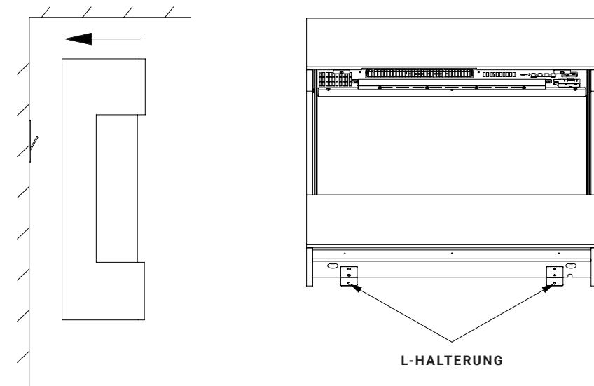
**2.1E** Bohren Sie die zwei Löcher mit einem 8mm Bohrer und setzen Sie die Dübel ein. Hängen Sie den Elektrokamin wieder ein und nutzen Sie die zwei Schrauben ST5 x 40, um die L-Halterung an der Wand zu befestigen.
