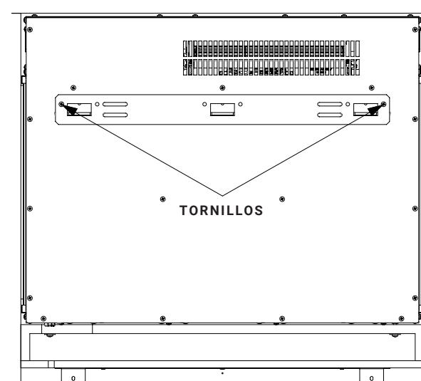
**2.1B** Elija una pared estable y marque los seis orificios del soporte de pared. Taladre los orificios marcados con la broca adecuada.
