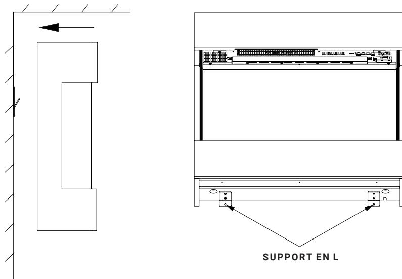
**2.1E** Percez les deux trous avec un foret de 8 mm et insérez les chevilles. Remettez la cheminée électrique en place et utilisez les deux vis ST5 x 40 pour fixer le support en L au mur.
