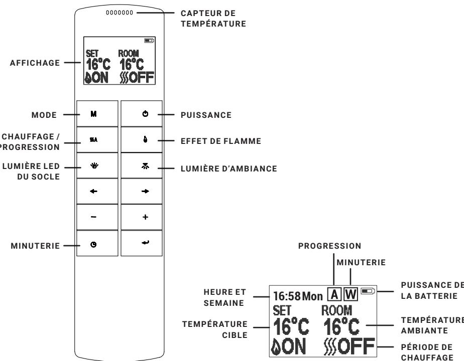
**REMARQUE :** Il s'agit d'une télécommande thermostatique. La télécommande doit se trouver dans la même pièce que le foyer et être placée sur une surface plane. La télécommande doit être tenue éloignée du foyer pour éviter que l'air chaud n'affecte pas la lecture thermostatique.
