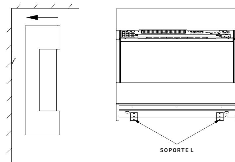
**2.1E** Taladre los dos orificios con una broca de 8 mm e inserte los tacos. Vuelva a colgar la chimenea eléctrica en su sitio y utilice los dos tornillos ST5 x 40 para fijar el soporte en L a la pared.
