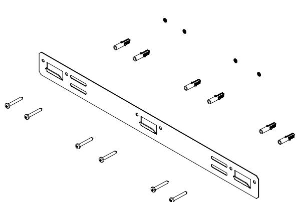
**2.1D** Cuelgue la chimenea eléctrica en el soporte de pared y marque los dos orificios de los soportes en L fijados en la parte inferior de la chimenea. Después, retire la chimenea.
