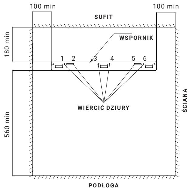
**2.1C** W wywiercone otwory włożyć kołki i użyć sześciu śrub ST5 x 40, aby przymocować mocowanie do ściany.
