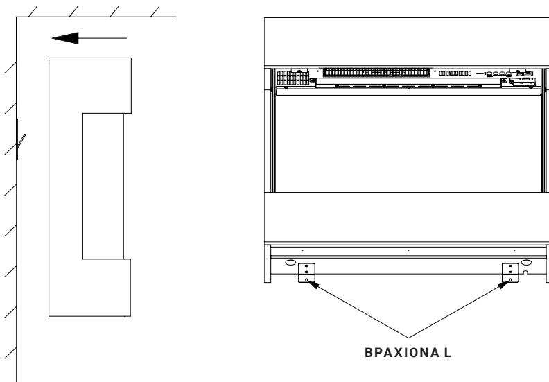
**2.1E** Ανοίξτε δύο οπές με τρυπάνι 8mm και τοποθετήστε τα βύσματα ούπατ. Αναρτήστε ξανά το ηλεκτρικό τζάκι και χρησιμοποιήστε τις δύο βίδες ST5 x 40, για να στερεώσετε στον τοίχο τη γωνία στήριξης L.
