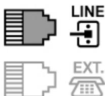
Stellen Sie beim Anschluss des Telefons an den Drucker sicher, dass der Drucker ausgeschaltet ist, stecken Sie ein Ende des modularen Kabels in die Buchse für externe Geräte in der Nähe der Markierung "EXT." am Drucker und stecken Sie das andere Ende in die Buchse für Telefonkabel am Telefon.
