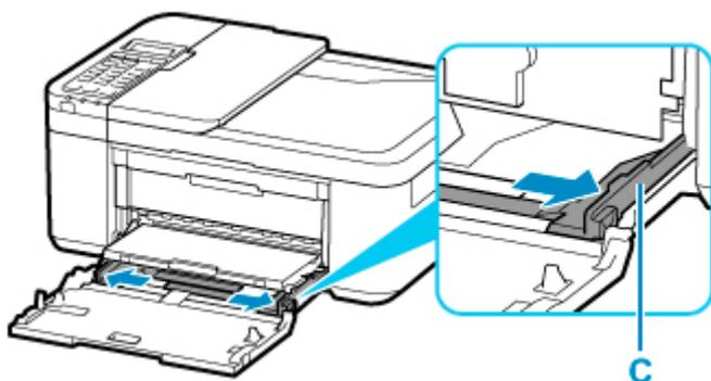
5. Legen Sie die Umschläge MIT DER ZU BEDRUCKENDEN SEITE NACH UNTEN in die Mitte der Kassette ein.
