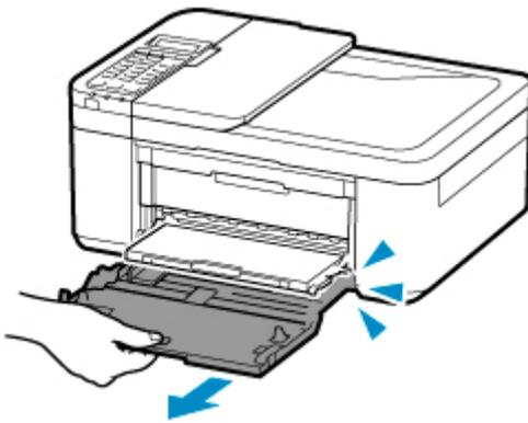
4. Schieben Sie beide Papierführungen mithilfe der rechten Papierführung (C) vollständig nach außen.
