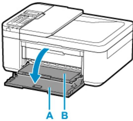
3. Halten Sie den Griffteil der vorderen Abdeckung und ziehen Sie die Kassette bis zum Anschlag heraus.
