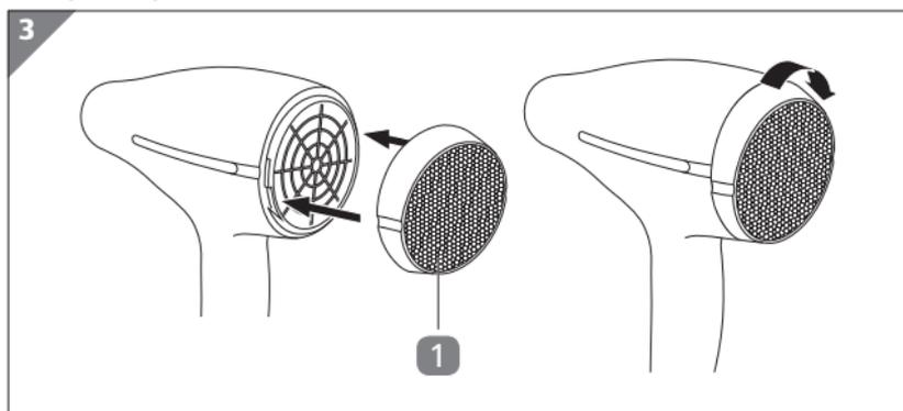
8. Lassen Sie das Produkt vollständig trocknen. Befestigen Sie anschließend wieder das abnehmbare Lufteinlassgitter **1**. Setzen Sie es auf die Aussparungen am Produkt und drehen Sie es im Uhrzeigersinn, bis es einrastet (siehe **Abb. 3**).
