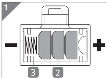
1. Öffnen Sie das Batteriefach **3** und legen Sie 3 Batterien **2** vom Typ LR41 ein (siehe **Abb. 1**). Achten Sie hierbei auf die richtige Polarität (+/-). Beim Austauschen der Batterien entnehmen Sie zuerst die alten Batterien.
