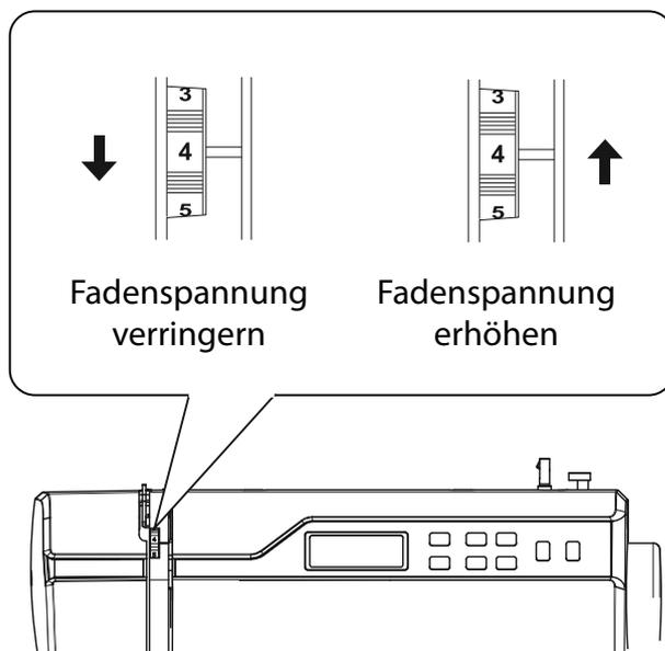
Eine Oberfadenspannung von 3 - 4 ist für die meisten Näharbeiten geeignet.
