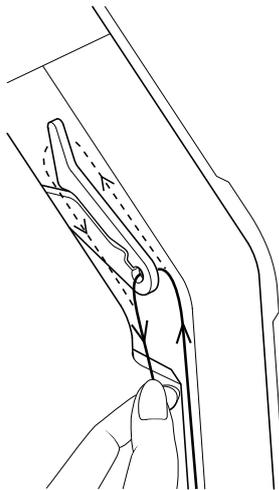
Drehen Sie ggf. am Handrad, um den Fadenheber bis oben anzuheben.
