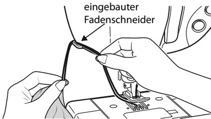
Durchtrennen Sie den Faden mit dem Fadenschneider **15** hinten an der Nähmaschine oder mit einer Schere. Lassen Sie ca. 15 cm des Fadens hinter dem Nadelöhr heraushängen.
