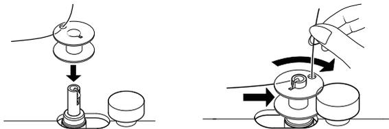
Nachdem die Spulenspindel auf der rechten Seite eingerastet ist, wechselt die LED-Anzeige von der Programmnummer zum Symbol „]“, gleichzeitig wird auch der Nähmechanismus abgeschaltet, so dass sich die Nadel während des Aufspulens nicht mitbewegt.
