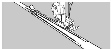
Bevor der Fuß den Schieber auf dem Reißverschlussband erreicht, heben Sie den Fuß nach oben und öffnen Sie den Reiß-
