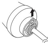
2 Ziehen Sie das Rohr aus dem Wasserinstallateur heraus.
