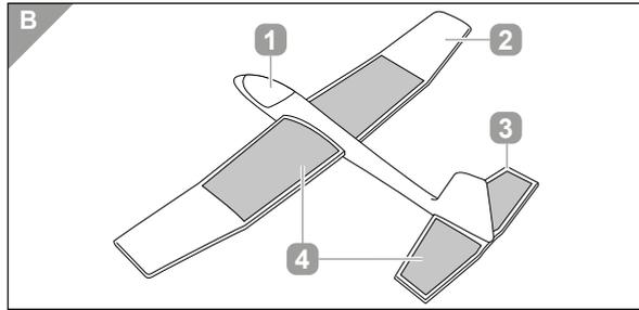
1. Schieben Sie die Tragfläche **2** bis zur Mitte in die vordere Öffnung des Rumpfes **1**. Die Spitzen der Tragfläche müssen nach oben zeigen.
