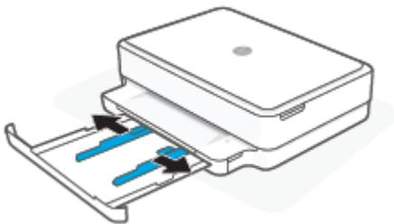
3. Legen Sie einen Stapel großformatiges Papier oder Fotopapier mittig in das Papierfach ein, wobei die kurze Kante zum Drucker zeigen muss. Vergewissern Sie sich beim Einlegen von Fotopapier, dass die zu bedruckende Seite nach unten zeigt. Schieben Sie dann den Papierstapel bis zum Anschlag hinein.
