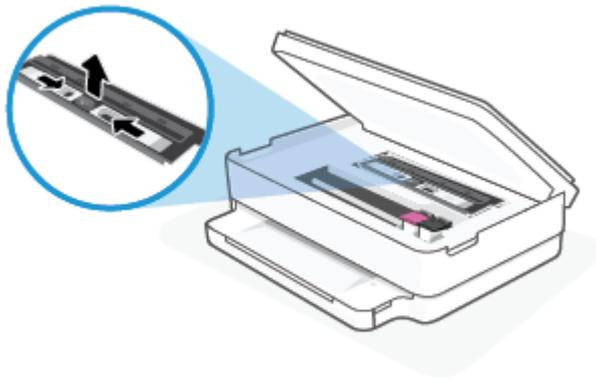
7. Befindet sich der Schlitten in der Mitte des Druckers, schieben Sie ihn nach rechts, und entfernen Sie dann Papier oder Gegenstände, die den Führungspfad des Schlittens blockieren.
