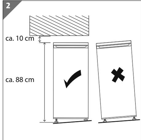
Um die Tür vollständig öffnen zu können, müssen die in **Abb. 1** und **2** aufgeführten Raummaße zur Verfügung stehen.
