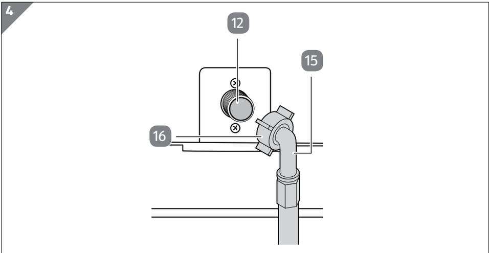
1. Schließen Sie den Zulaufschlauch **15** am Produkt an, indem Sie die Schlauchmutter **16** händisch auf den Wasserzulauf **12** schrauben (siehe **Abb. 4**).
