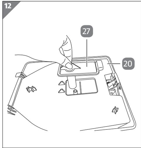
2. Halten Sie die Verschlussstaste **26** gedrückt und entnehmen Sie den Waschmittelkasten **20** an der Innenseite des Deckels (siehe **Abb. 11**).
