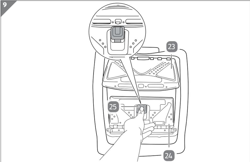
2. Halten Sie mit einer Hand die Verschlussaste **25** gedrückt und sichern Sie mit der anderen Hand die hintere Trommelklappe **23** (siehe **Abb. 9**)
