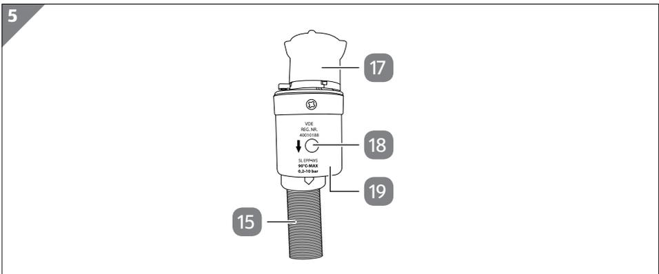
3. Schrauben Sie die Überwurfmutter **17** händisch auf den Wasserhahn (siehe **Abb. 5**).
