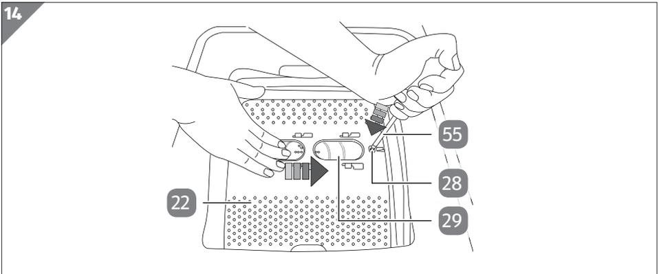
4. Drücken Sie mit einem Schraubendreher **55** auf das Kunststoffende **28**, während Sie den Schieber **29** von links nach rechts schieben (siehe **Abb. 14**).
