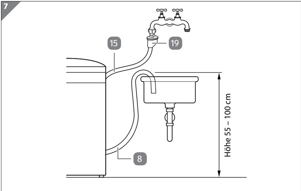
2. Schließen Sie den Ablaufschlauch am Abwasserabfluss an oder leiten Sie den Ablaufschlauch in einen geeigneten Abfluss (siehe **Abb. 7**).
