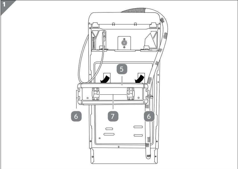
1. Drehen Sie mit einem Sechskantschlüssel 8 mm **53** die beiden Befestigungsschrauben **7** und die vier Außenschrauben **6** entgegen dem Uhrzeigersinn heraus (siehe **Abb. 1**).
