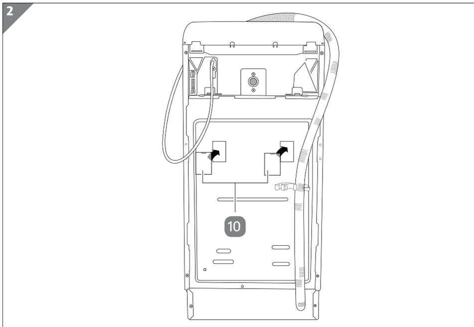
4. Setzen Sie die beiden Abdeckungen **10** in die entsprechenden Öffnungen für die Transportsicherung (siehe **Abb. 2**).
