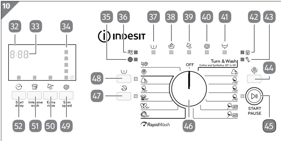
2. Stellen Sie das Waschprogramm ein, indem Sie den Programmwahlschalter **46** stufenweise im oder entgegen dem Uhrzeigersinn drehen, bis die Markierung auf das gewünschte Waschprogramm zeigt (siehe **Abb. 10** und Kapitel „Übersicht Waschprogramme“).
