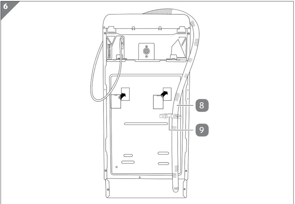
1. Entnehmen Sie den Ablaufschlauch **8** aus dem linken Clip **9** (siehe **Abb. 6**).
