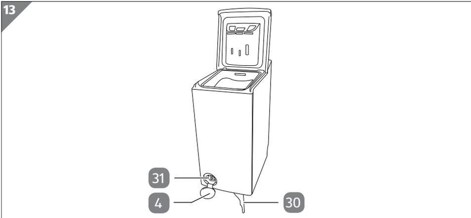
2. Öffnen Sie die Filterabdeckung
